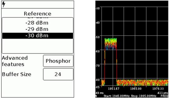
Figure 8.5.6 - Measurement in the «Digital Phosphor» mode
