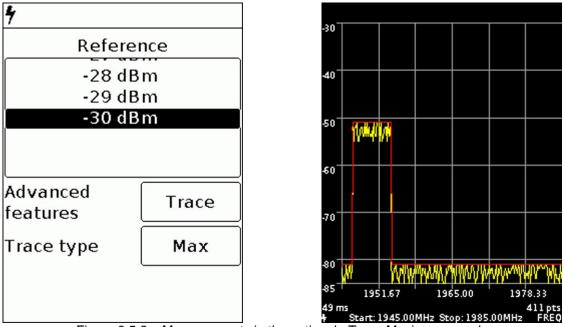
Figure 8.5.2 - Measurements in the optional «Trace Maximum» mode
